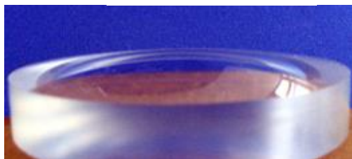
図2プラスチックレンズの鏡面加工例
