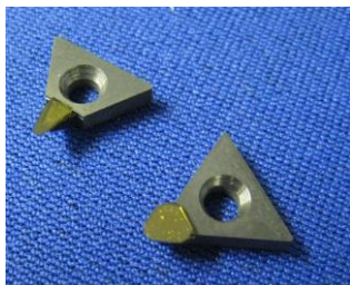
図7 専用単結晶ダイヤモンド工具
