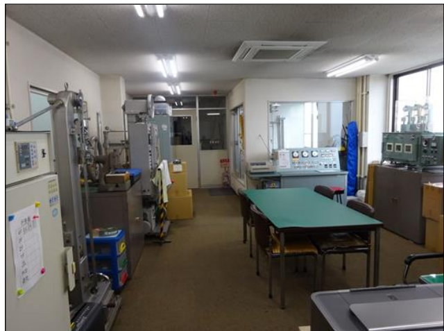
製品検査室 右奥が配電機材用耐圧試験装置
